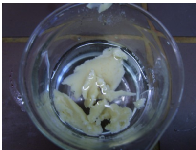
Abb. 2: Rückstand des Siedens in Natriumchloridlösung
