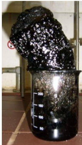
Abb. 1: In einem Becherglas wird der Zucker mit Schwefelsäure verkohlt.
