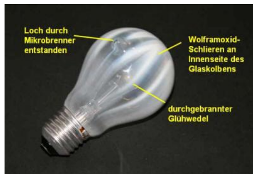
Abb. 7: Glühbirne mit Wolframoxidniederschlag (Quelle: http://daten.didaktikchemie.uni-bayreuth.de/umat/wolfram/gluehbirne.jpg )
