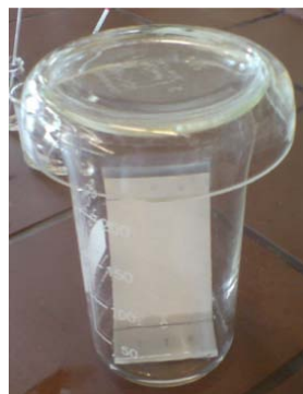
Abb. 3: DC-Kammer mit vorbereiteten DC-Karten und Fließmittel
