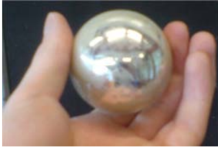
Abb. 2.: Rundkolben mit Silberschicht
