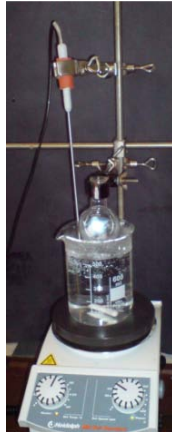
Abb. 1.: Wasserbad mit fixiertem Rundkolben
