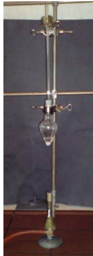
Abb. 1.: Brenner und Kolben (mit Glasrohr als Rückflusskühler)
