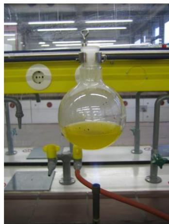
Abb. 4: Ansatz mit Schwefelsäure, der zum Sieden gebracht wird.
