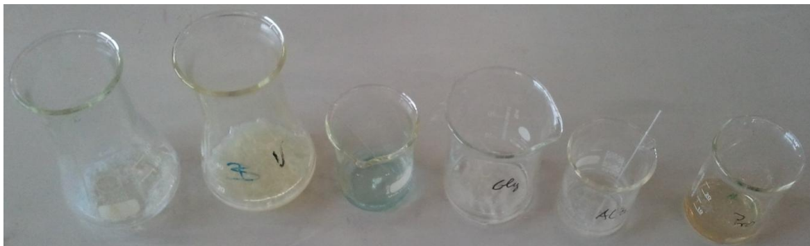
Abb. 5: Schlechte Löslichkeit des Gelatine-Hydrolyсата, Fruchtbromelains, der Gelatine, Glycins und Alanins (v.l.n.r.) in Methanol. Mäßige Löslichkeit von Prolin (rechts).
