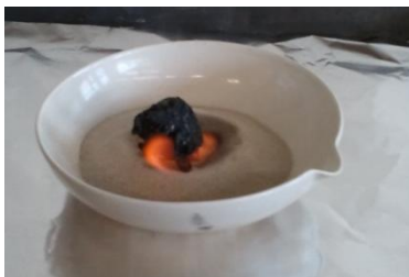
Abb. 2: Aufsteigen einer schwarzen Kohlenstoff-Schlange im Laborversuch .
